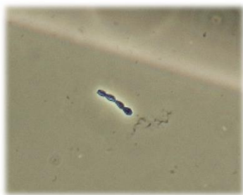
写真. 石綿小体、位相差顕微鏡 x400
